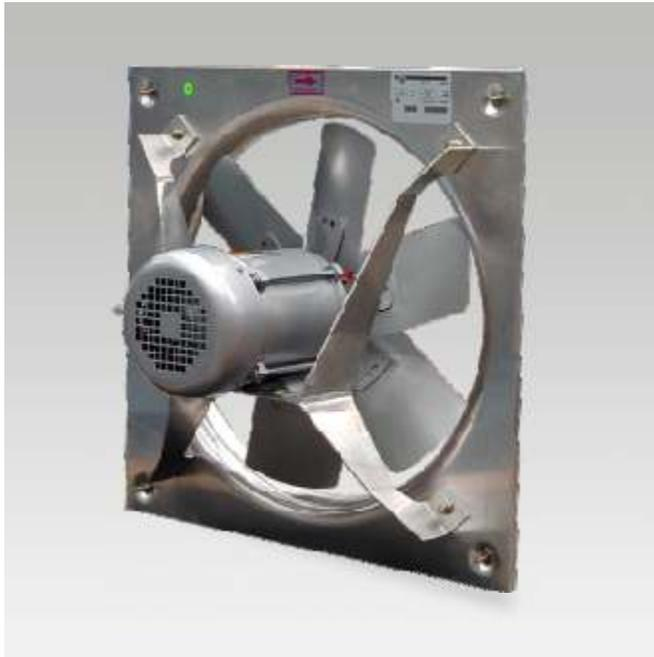
Los extractores de tipo helicoidal modelo HEP cuenta con tres tamaños que cubren un gran rango de prestaciones con gran eficiencia; han sido desarrollados para operar en ambientes de riesgo explosivo, en base a normas internacionales ya que el conjunto embocadura-hélice-motor, forma un sistema antichispa, en base a la norma AMCA STANDARD 99-0401-86.
